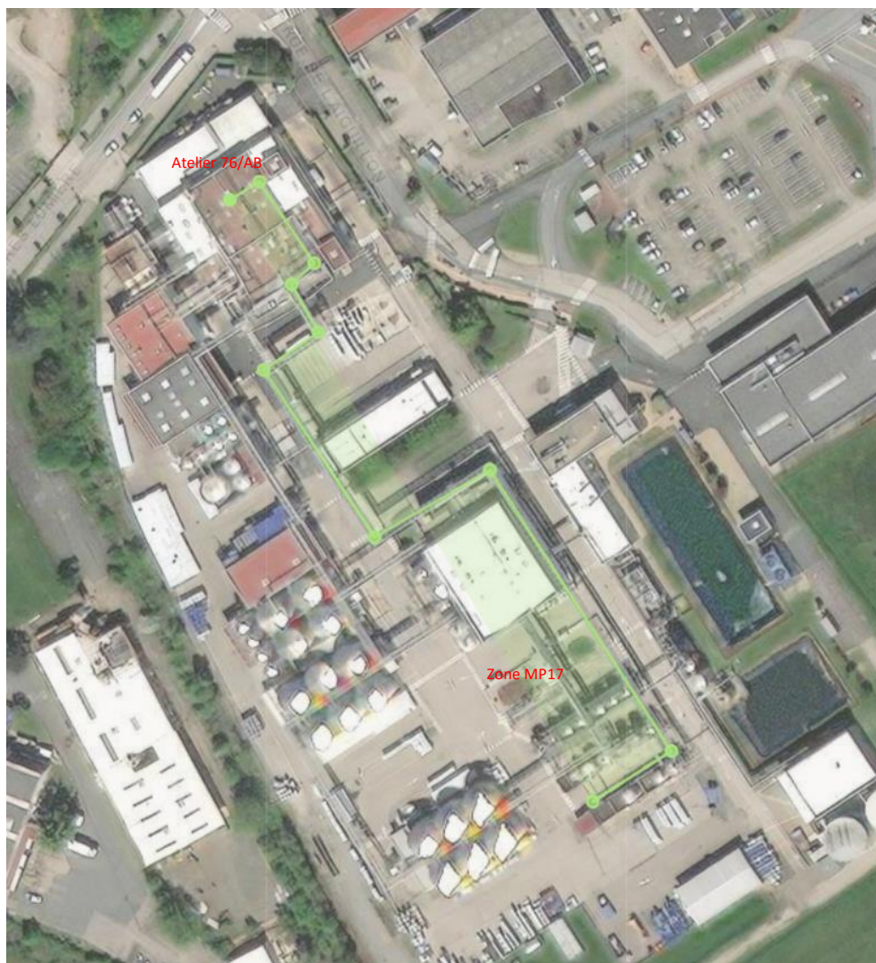
Photo de cheminement du circuit d'IPDI depuis la zone MP17 vers l'atelier 76/AB
