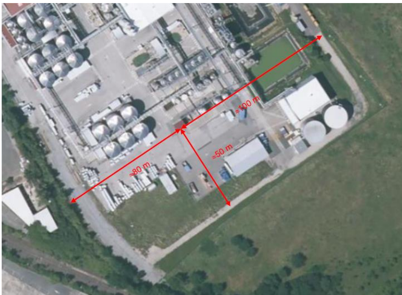
Distances entre l'emplacement de la future cuve et les limites de propriétés
